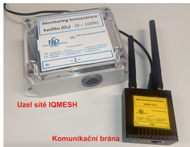
Obr. 1 Ukázka sestavy bezdrátového senzoru a komunikační brány pro kontinuální měření koncentrace kyslíku a teploty v uzavřených prostorech
