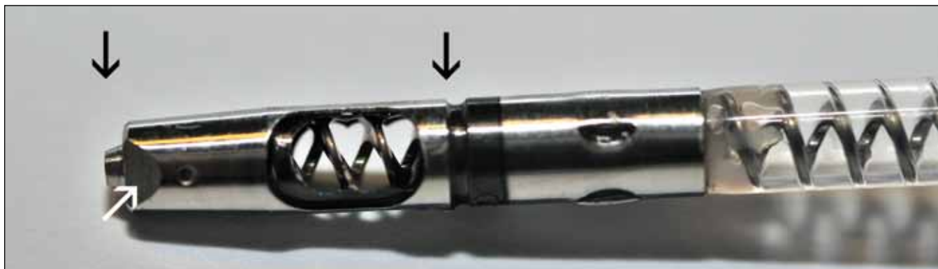
Obr. 6a. Obrázek funkčního zakončení zařízení rotarex sloužícího k trombektomii. Mezi černými šipkami je konus rotující rychlostí 40 000 otáček/min. Bílá šipka označuje plochy vytvářející vír. Po fragmentaci sraženiny je tato nasávána do okénka rotujícího kuželu a spirálou odnášena do sběrného vaku umístěného mimo pacienta. Tímto zařízením lze odstranit relativně velké objemy krevní sraženiny v krátkém čase.
